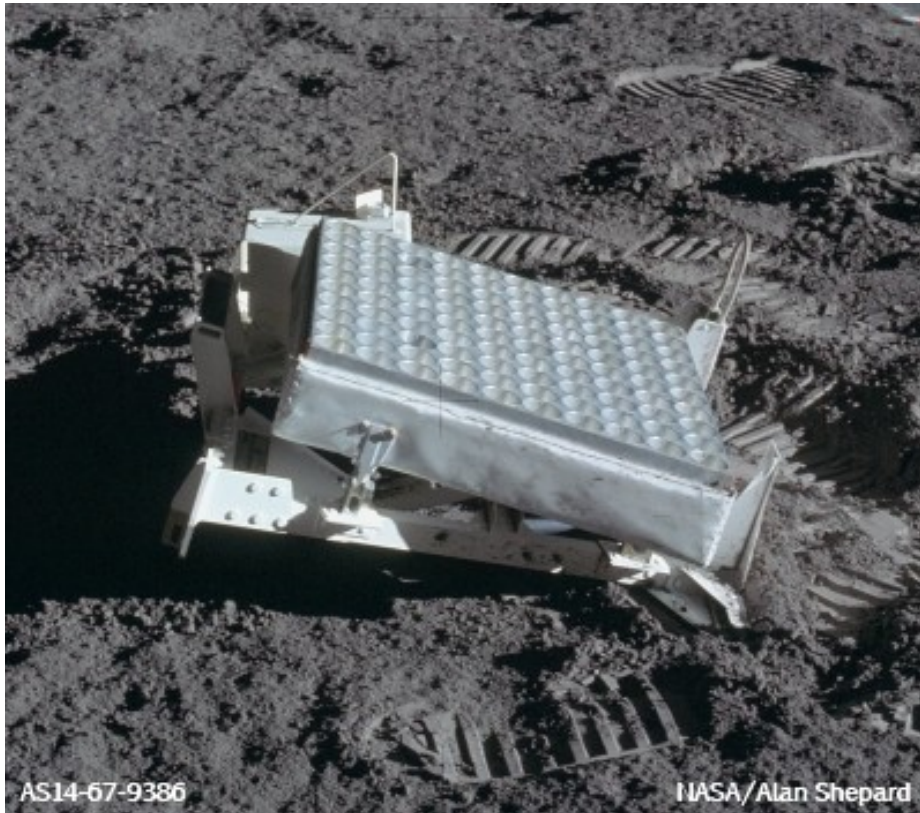
Εικόνα 13: Ανακλαστήρας στην επιφάνεια της Σελήνης [13].
