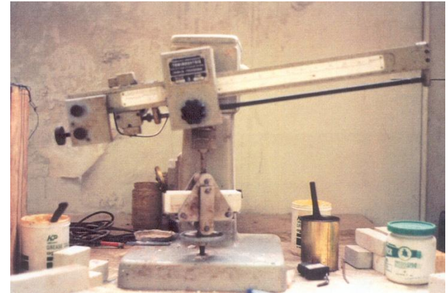
Συσκευή ελέγχου αντοχής σε κάμψη
