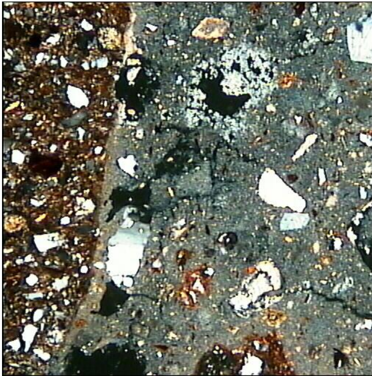
Μικροδομή κονιών με πολωτικό μικροσκόπιο
