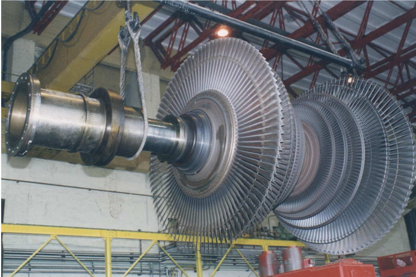
Εικόνα 7: Στροφέιο στροβίλου ΧΠ
