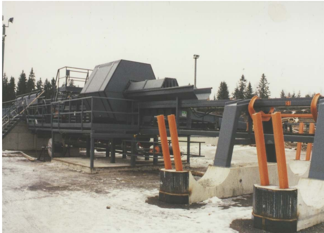
Εικόνα 4.6. Σάρωση κορμών με scanner
