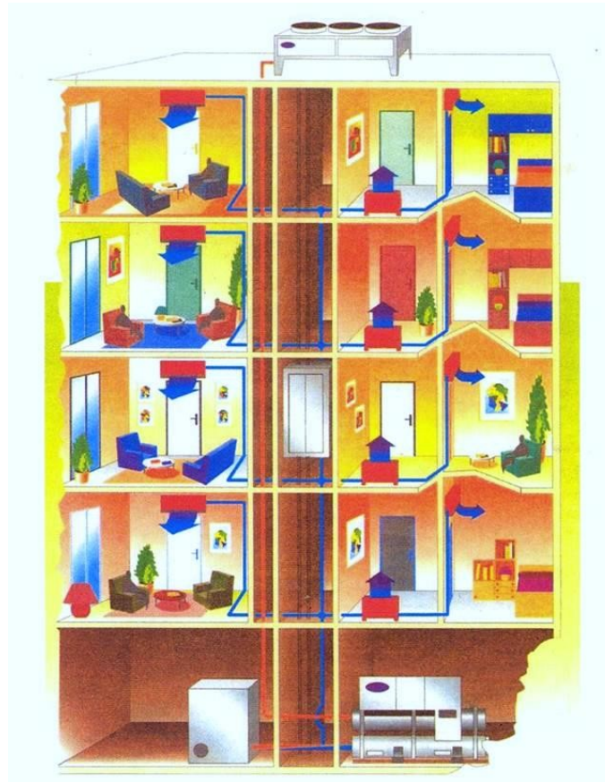
Εικ.59: Σύστημα κλιματισμού με νερό και FCU
