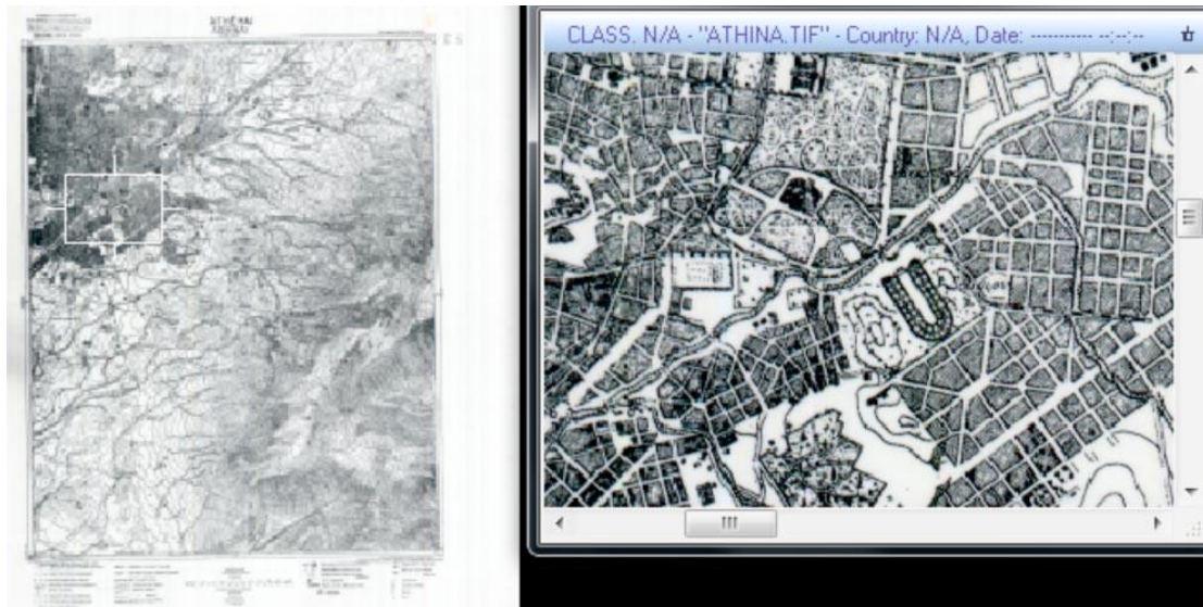
Εικόνα 3. Θέαση ορθοεικόνας στο AutoCAD. Η τοποθέτηση του δείκτη του ποντικιού πάνω σε ένα σημείο της απεικονιζόμενης περιοχής θα πρέπει να εμφανίζει τις συντεταγμένες του στο προβολικό σύστημα ΕΓΣΑ'87.
