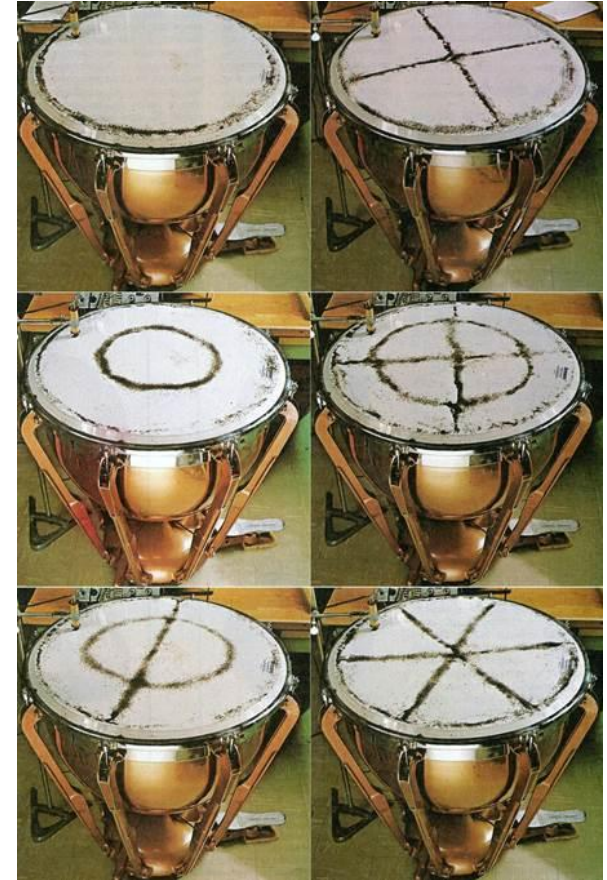
διάφοροι τύποι δονήσεων σχηματισμοί Κλάντι. Η άμμος, πάνω σε δονούμενη πλάκα, συγκεντρώνεται στα σημεία που μένουν ακίνητα
