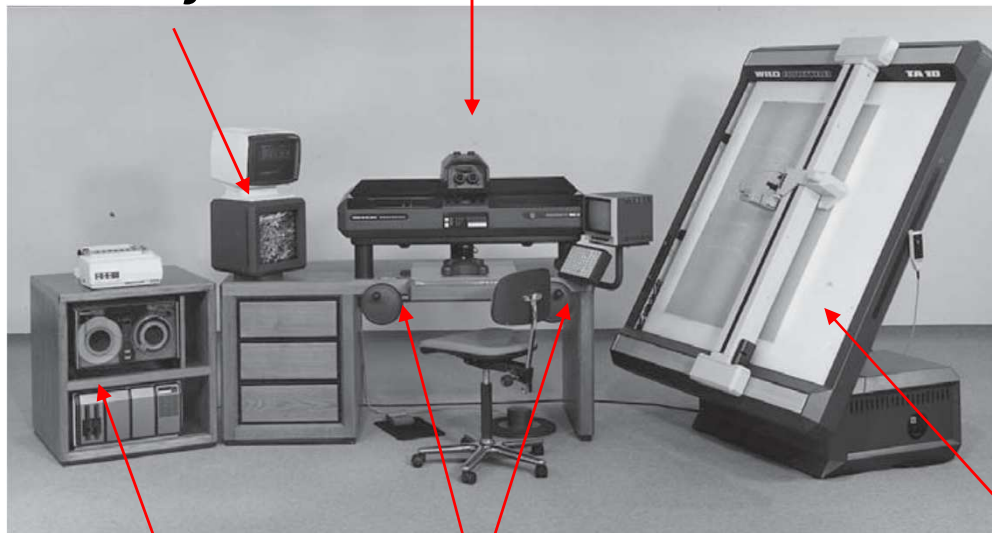
Εικ. 26 Analytical plotting system BC1/TA10 Wild
