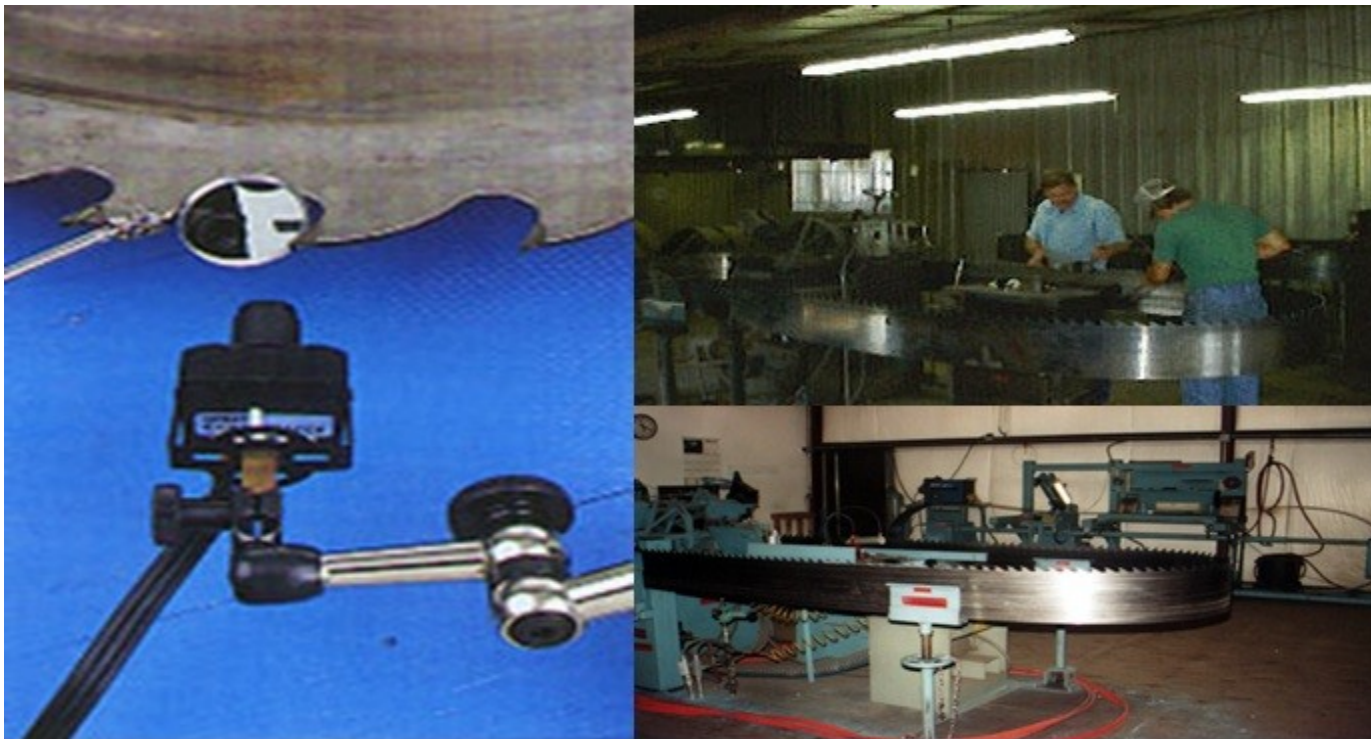
Εικόνα 3.28. Εγκαταστάσεις για τρόχισμα ταινιοπριονίων
